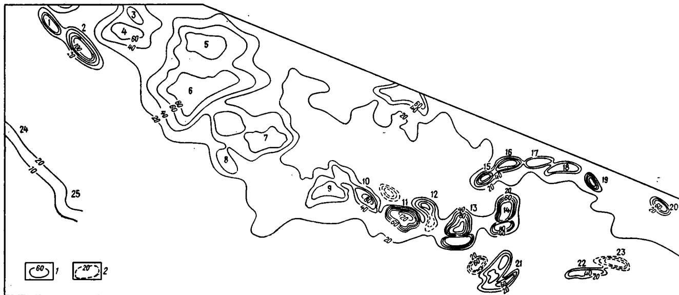
Рис. 9. Схематическая карта суммарной эффективной мощности верхнеюрских карбонатных отложений Восточной Туркмении и Западного Узбекистана.
