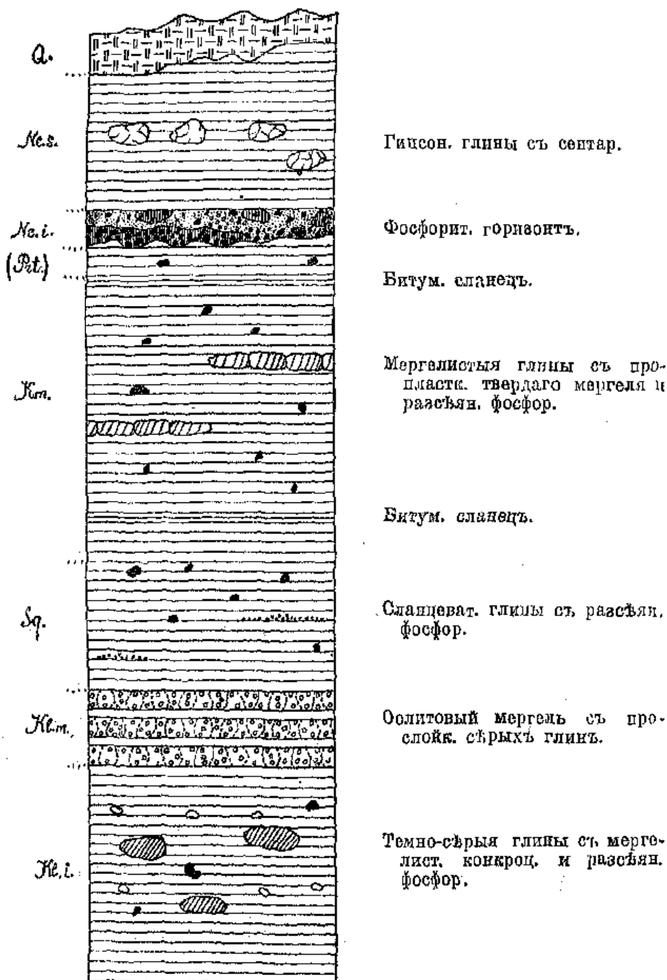
Рис. 2. Схема распределенія фосфоритовъ въ мезозойскихъ отложенияхъ западной части Курмышскаго уѣзда.
