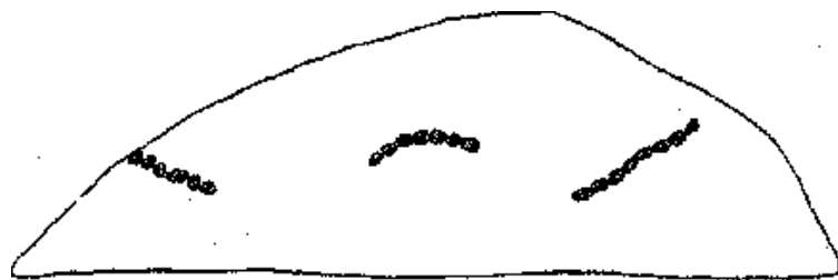
Рис. 7. Схема залеганія разорваннаго фосфоритоваго слоя въ порландскихъ глинахъ въ обнаженіи близъ д. Карвужемской [56].
