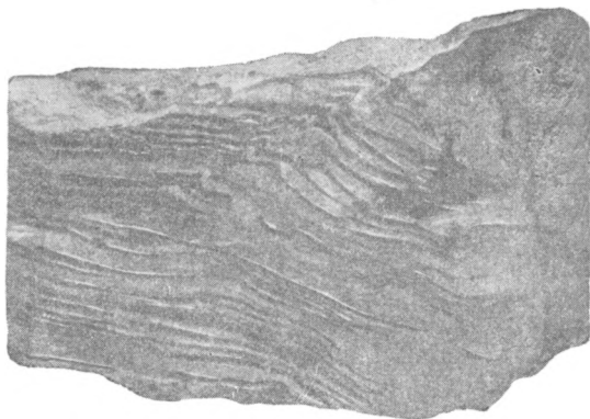
Рис. 4. Косая слоистость в алевролитах чонгур-гасской свиты (светлые слои — алевролит с ломонитовым цементом порово-базального типа; натуральная величина)
