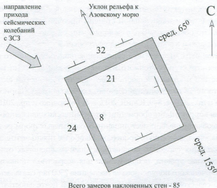
Рис. 16. Схематическая модель построек Полянки. Большая часть субширотных стен наклонилась на север – по уклону рельефа (хотя 2/5 от общего числа этих стен наклонилась в противоположную сторону), субмеридиональные стены наклонились преимущественно на восток, что никак не связано с рельефом. Сейсмические колебания распространялись с ЗСЗ
