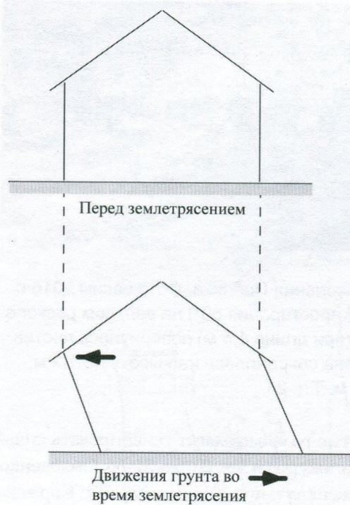
Рис. 5. Схема деформации здания при сильных землетрясениях по [Rapp, 1986], с изменениями
