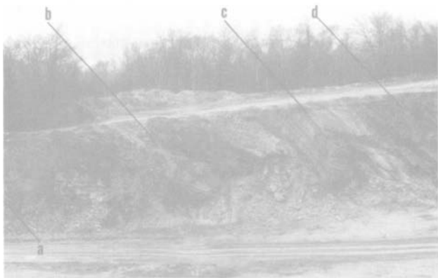
Abb. 9: Aufschlußpunkt 4: Hohes Ober-Turon, hohe grau-weiße Kalkstein-Einheit (rechts von a) in überkippter Lagerung.
