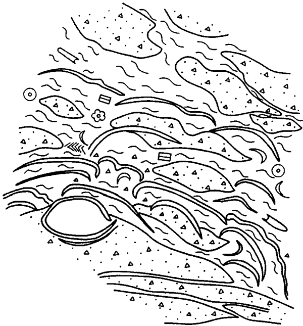
Рис. 26. Ненасыщенный крупносkeletalный камерный инфлаутстоун; оригинальная биогенная текстура – “мостовая” (скв. Южно-Табаганская-134, обр. И28586-4, инт. 3094,4–3100,0 м, н.к.).
