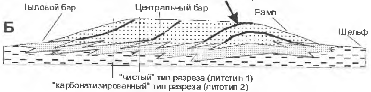
Рис. 2.30. Схема распределения литотипов разрезов продуктивного пласта Ю 1 2 Игольского месторождения (по данным эксплуатационного бурения)
