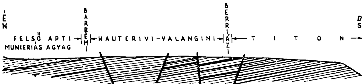
21. ábra. Szerkezeti szelvényvázlat a Lókúti legelő Ny-i vágéről Abb. 21. Schematisches tektonisches Profil vom W-Ende der Lókúter Weide
