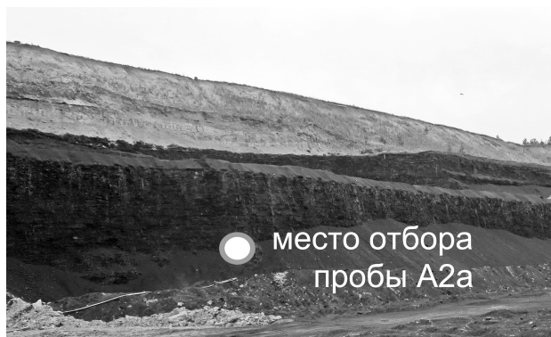
Рис. 1. Угольный пласт «Мощный» Абанского месторождения Канско-Ачинского бассейна Красноярского края, бородинская свита, средняя юра. Кружком показано место отбора самой продуктивной пробы А2. Мощность угольного пласта в этом месте 9 м.
