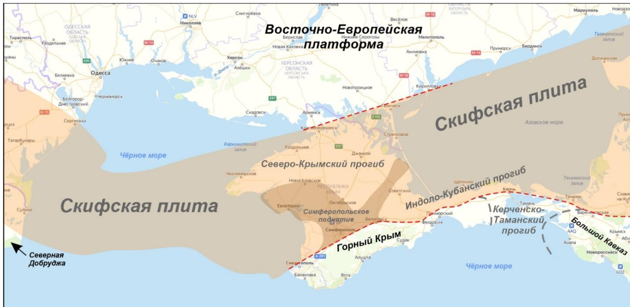
Рис. 2-1. Крым на тектонической схеме южной окраины Восточно-Европейской платформы (по Starostenko et al. (2015), максимально упрощено). Эпигерцинская Скифская плита (светло-коричневый фон), в пределах которой расположен Степной Крым, на севере граничит с Восточно-Европейской платформой по Северо-Крымскому позднепалеозойскому шву/сутуре (Юдин, 2011; Никишин, Ершов, 2004). На юге граница Скифской плиты с Горным Крымом проходит по Предгорной мезозойской сuture (Юдин, 2011), часто именуемой Симферопольским разломом, но также известной как Лозовская зона смятия.
