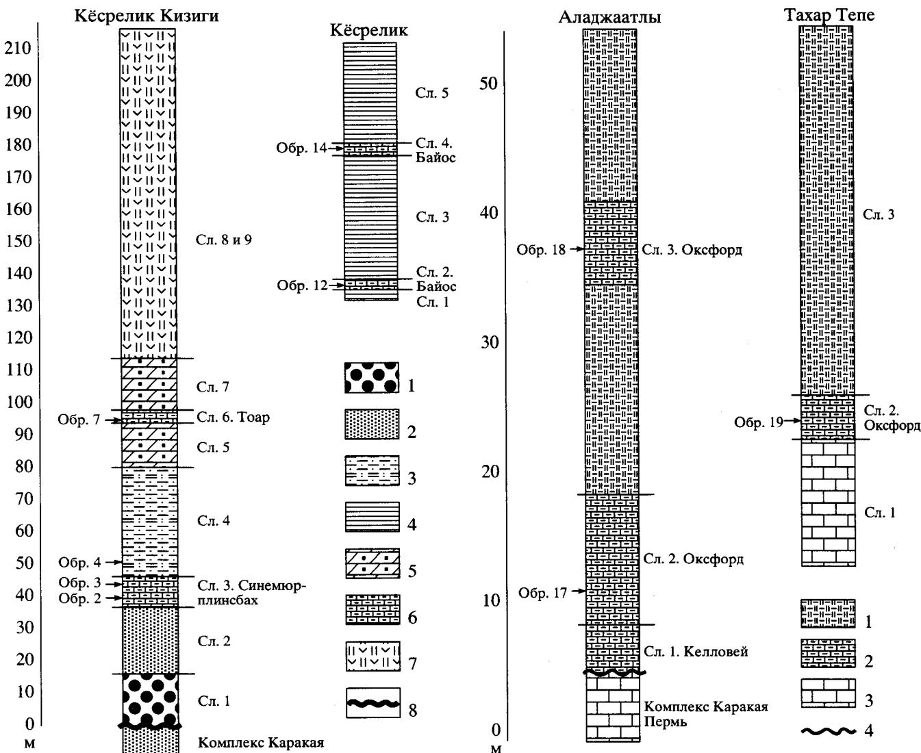
**Рис. 2. Разрезы нижней и средней юры района Анкары.** Номера слоев и их возраст по фораминиферам показаны справа от стратиграфических колонок соответственно описанию в тексте; положение образцов с фораминиферами – слева от стратиграфических колонок.
